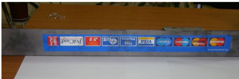
Fot. 2. Listwa naklejona na bankomat, w której zamontowano urządzenia rejestrujące obraz
