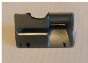
Fot. 1. Nakładka zamontowana na czytniku kart
