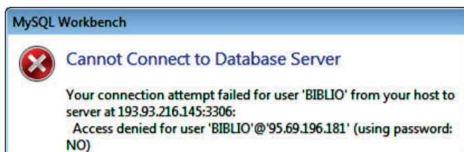
Рис. 12.29. Причина помилки Cannot Connect to Database Server – не заданий пароль
