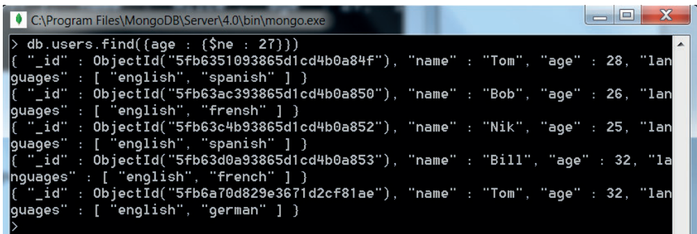
Рис. 14.45. Вивід документів з обмеженням на значення поля age ≠ 27
